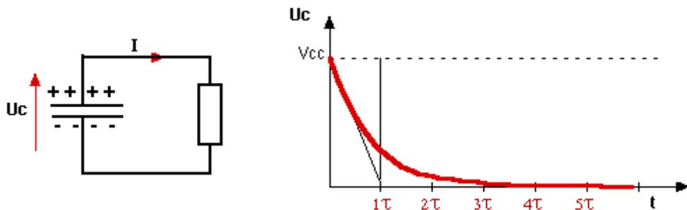
La tension diminue avec le temps selon une courbe symétrique à celle de la charge
