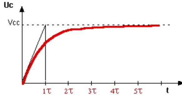
La durée de la charge est fonction des valeurs de R et C, le produit RC est nommé la constante de temps et exprimé en secondes
