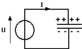
Rq : Aucun électron ne traverse le condensateur, le diélectrique est un isolant.
