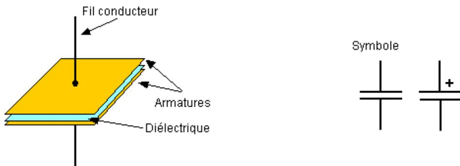
La caractéristique principale d'un condensateur est sa capacité exprimée en **farad**
